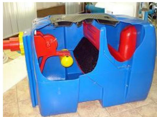
Рис 2. Нефтеулавливатель
