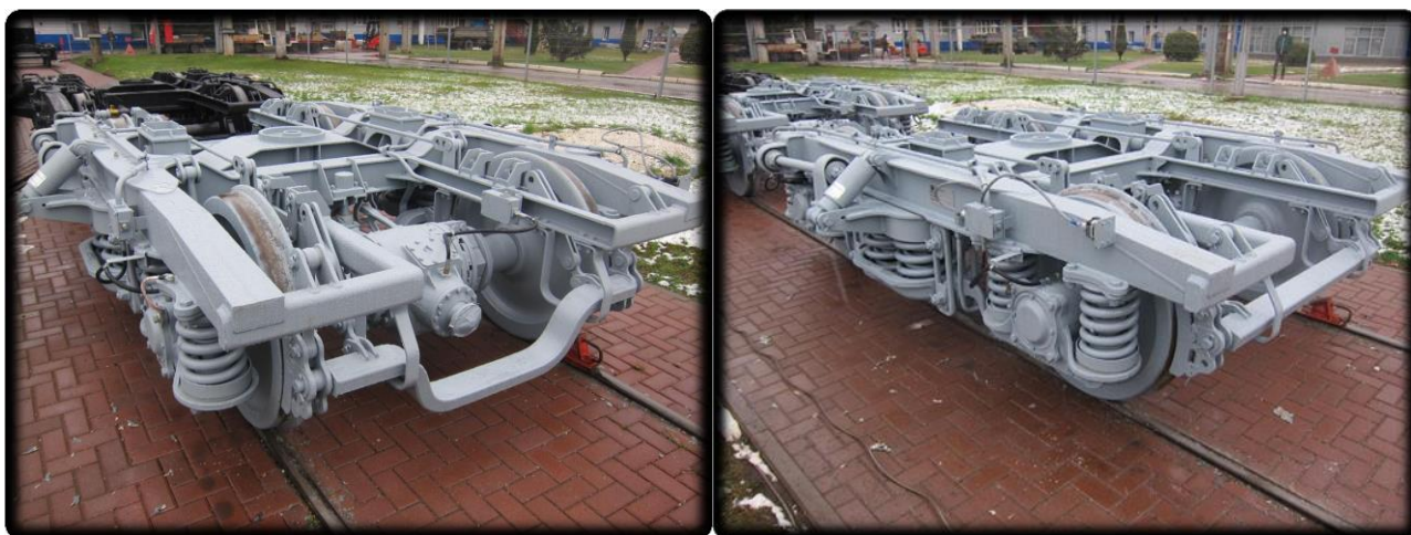
Тележки модели 65-4065 68-4066 (привод генератора)
