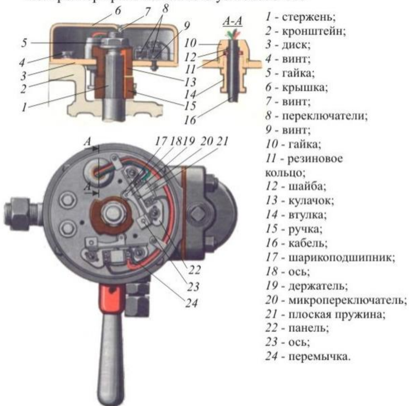
Рисунок 1 - Контроллер крана машиниста усл. №395-000.
