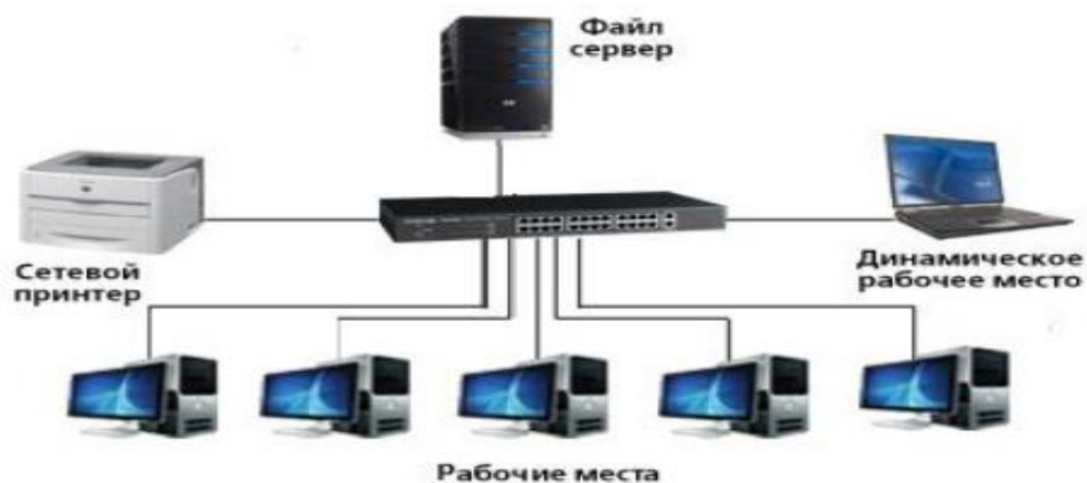
Рис.2. Пример построения сети с выделенным сервером
