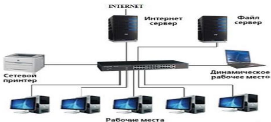
Рис.2. Пример построения сети с выделенным сервером
