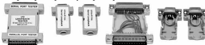
Рис. 1.18. Внешний вид, внутреннее устройство типичных тестовых разъемов
