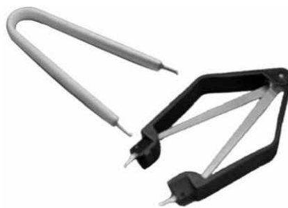
Рис. 1.17. Приспособления для извлечения микросхем из гнезд
