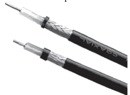
Рис. 4. Устройство коаксиального кабеля 1 — внутренний проводник (медная проволока), 2 — изоляция (сплошной полиэтилен), 3 — внешний проводник (оплётка из меди), 4 — оболочка (светостабилизированный полиэтилен).
