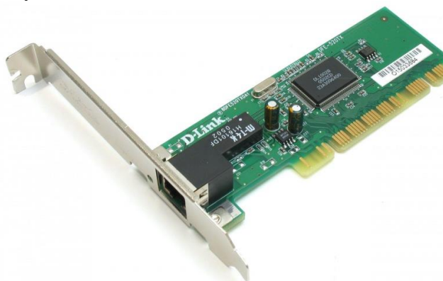
Рис. 6. Сетевая карта в виде платы расширения, устанавливаемой в PCI-слот
