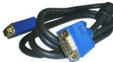
Рисунок 11 – кабель подключения системного блока к монитору
