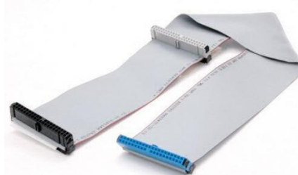
Рисунок 9 - Шлейф для подключения IDE устройства
