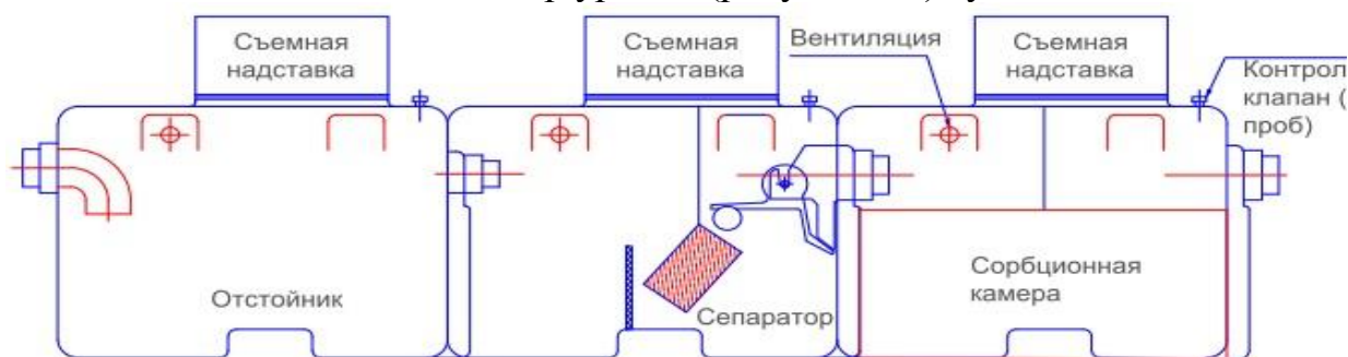
Рисунок – 1Схема нефтеловителя
