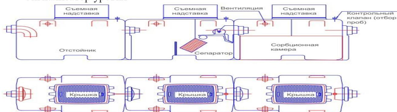
Предлагаемые нефтеловушки выполнены из полиэтилена. Они оборудованы встроенной камерой для сбора осадка. В процессе сепарации используется разница плотности нефтепродуктов и воды в процессе гравитационного расслоения потока через нефтеуловитель.
